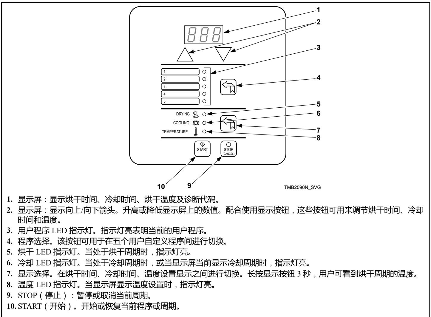
1. 显示屏：显示烘干时间、冷却时间、烘干温度及诊断代码。
